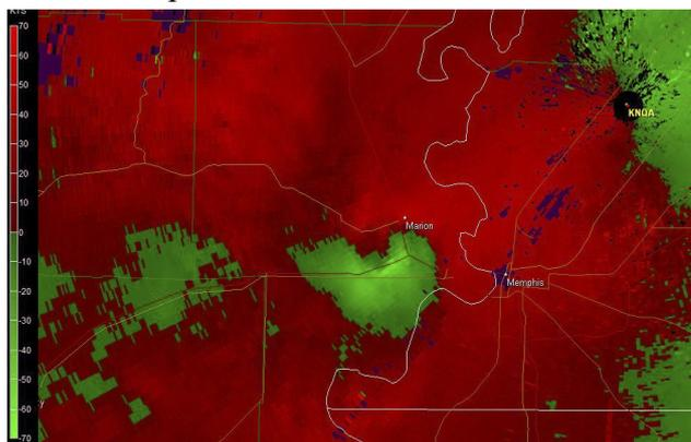
Si noti come in una zona abbastanza ristretta sono contrapposte velocità negative a velocità positive (osservando la legenda): questo significa che da un lato i venti si avvicinano al radar e dall'altro si allontanano. Questo è possibile solo se vi è rotazione.
